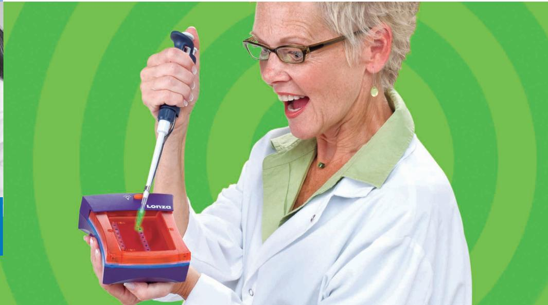
FlashGel™ システムはプレキャストゲルカセット式の核酸電気泳動システムです。このシステムは、プレキャストアガロースゲル用の使い捨てカセットと電気泳動・トランスイルミネーター装置で構成されます。高感度および高分解能であり、DNAあるいはRNAも泳動可能です。
